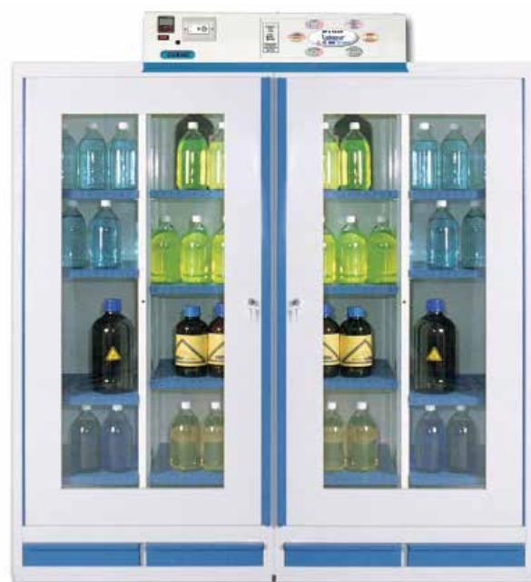
Modèle "AF 4-4" - Enceinte Double Compartimentée Dimensions extérieures : 1900 x 1600 x 545 mm poids 300 Kg Dimensions intérieures : (1500 x 380/380 x 500 mm) x 2 16 Demi-étagères Capacité de stockage 240 L
