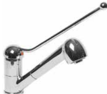
Mitigeur Douchette à Commande « Coude » Mitigeur à bec lisse orientable Douchette sur Flexible Extractible Hauteur sous bec 126 mm Saillie 210 mm Flexible SPEX M10 x 1, EP G3/8, longueur 350 mm Aérateur étoile M24 x 1
