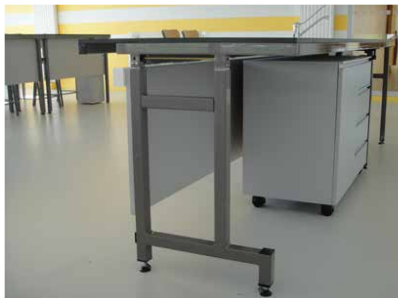
Poste PMR avec plan de travail réglable en hauteur par manivelle, et plot technique adapté au passage d'un fauteuil roulant.
