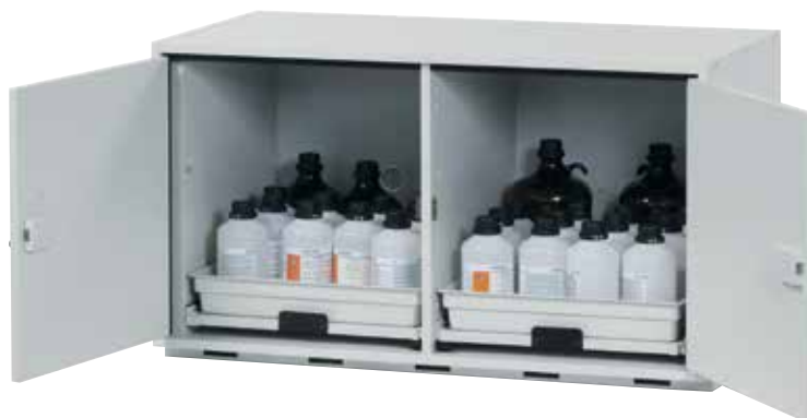
Armoire sous Paillasse 2 Compartiments Acides/Bases à 2 Tiroirs Extractibles - ASE 61930620 Dimensions 1100 x 570 x 600 mm 60 Kg. Capacité des Bacs 18 Litres. Charge admissible 100 Kg. Renouvellement d'air 8.8 m 3 /h. En option, les armoires peuvent être équipées d'un socle à roulettes de hauteur 30 mm.
