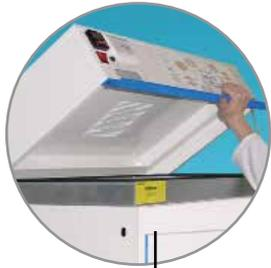
Fenêtre de Contrôle de la présence du filtre adapté à vos besoins (couleurs normatives)
