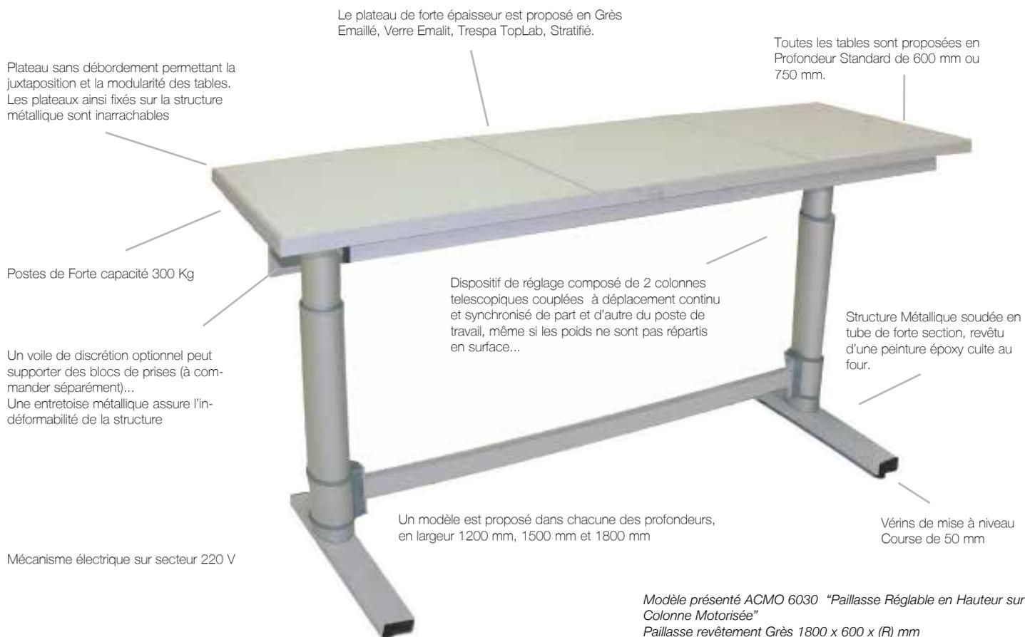
Modèle présenté ACOMO 6030 "Paillasse Réglable en Hauteur sur Colonne Motorisée"
