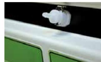
La Sonde de Prélèvement permet la détection manuelle de l'état de saturation du filtre à l'aide de tubes réactifs
