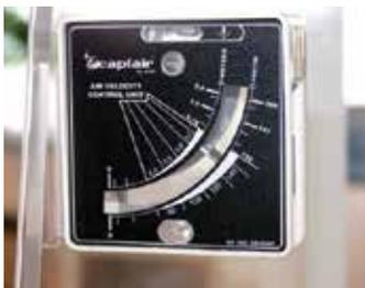
Mesureur de Flux d'Air, Le système contrôle en permanence les vitesses d'air en façade et à l'intérieur de l'enceinte
