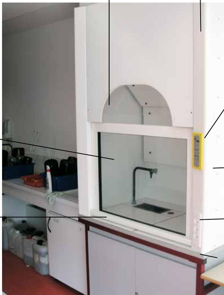
Essais de Confinement par la mesure de concentration d'un gaz traceur SF6 en 6 points sous un débit continu: Maximum mesuré sur les SafeLab-I, 0,056 ppm pour une norme de 0,1 ppm.
