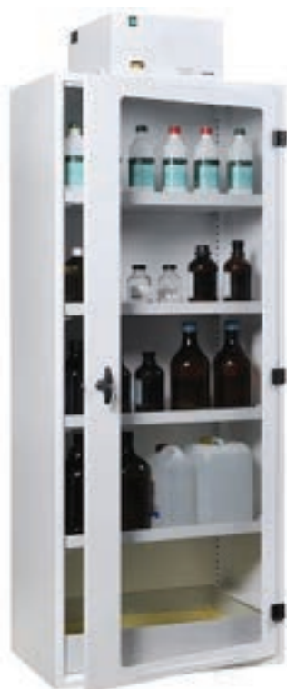
Modèle "AFA 80" Enceinte simple Non Compartimentée Dimensions extérieures : 2160 x 800 x 500 mm poids 105 Kg Dimensions intérieures : 1860 x 726 x 474 mm 4 Etagères de charge 60 kg Capacité de stockage 180 L Capacité du bac de rétention 39 L
