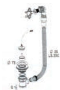
Accessoire vidage trop plein pour dalle ou cuve. Raccordement mâle 1 1/4, à compléter par un siphon. Garantie 10 ans contre tout vice de fabrication
