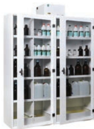
Modèle "AF 8082" Double Enceinte 1 Enceinte compartimentée et 1 enceinte Non Compartimentée : 2160 x 1600 x 500 mm poids 170 Kg Dimensions intérieures : 2 x (1860 x 726 x 474 mm) 1 x 4 Etagères de charge 60 kg 2 x 4 Demi-Etagères de charge 60 kg Capacité de stockage 350 L Capacité du bac de rétention 1x 39 L / 2 x 19 L
